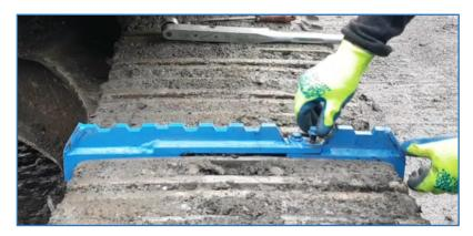
STEP 2: PUT THE SMALL PART ONTO THE TRACK PAD
